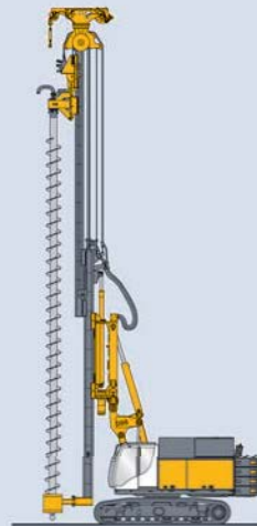
MB オーガ掘削 Auger drilling
