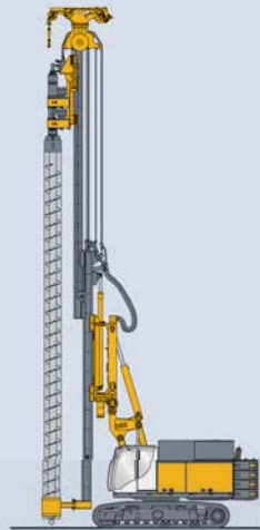
VdW ケーシング付きオーガ Front-Of-Wall drilling
