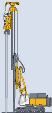
MR 油圧バイブロ Hydraulic vibrator
